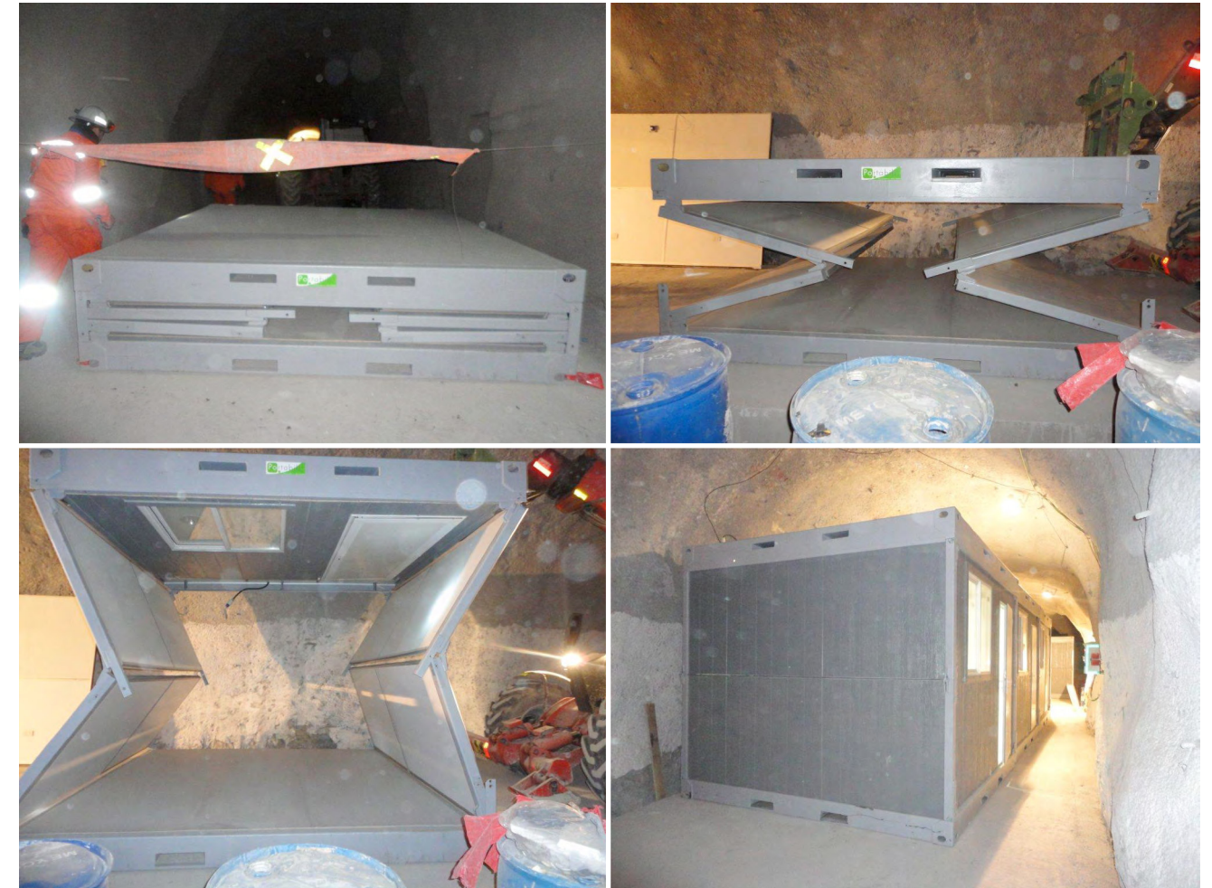
Figura 1.- Contenedor diseñado para accesos restringidos o estrechos.
